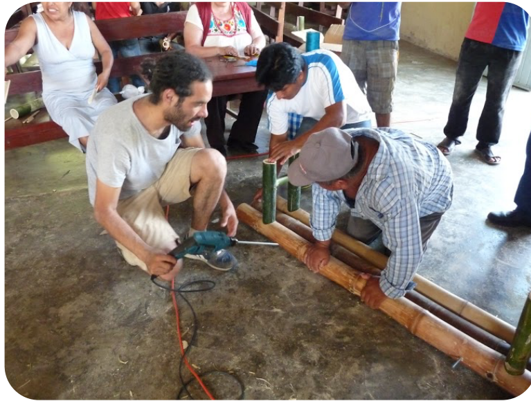
Unión del asiento con espárrago metálico.
