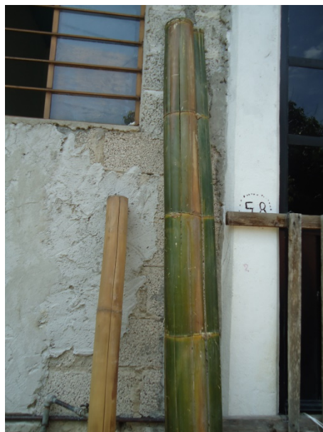
Esterilla con bambú tratado y con bambú verde.
