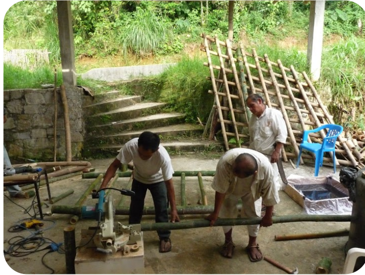
Señores cortando los culmos para la cama de bambú.
