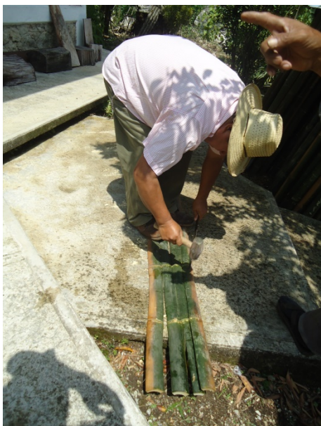
Obtención de esterilla con bambú oldhamii .
