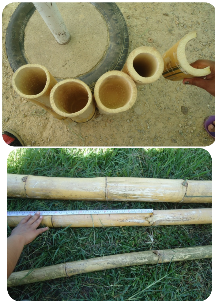
Medidas de entrenudos y grosor de pared de los bambúes utilizados en el taller.
